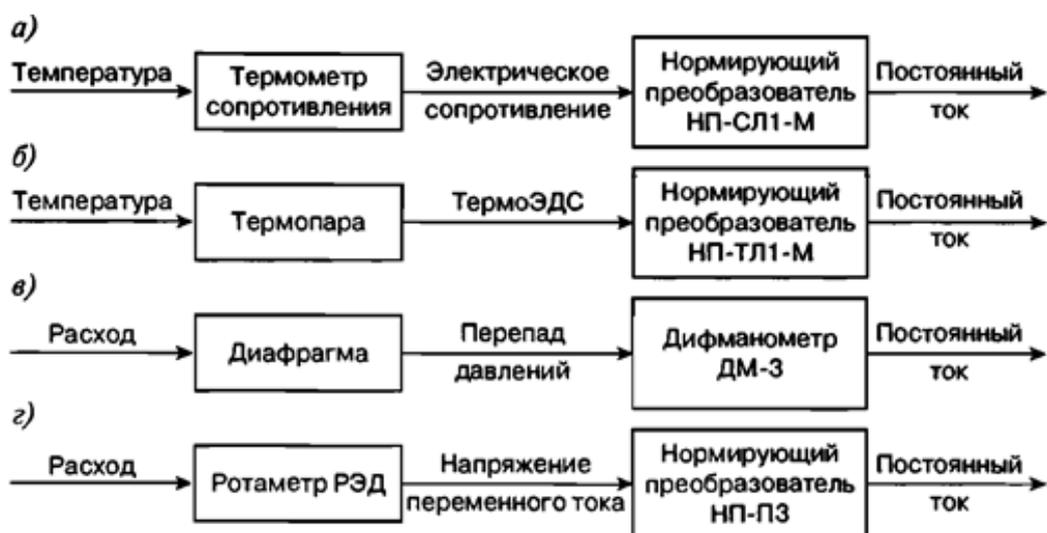
Рис. 4.9. Примеры измерительных цепей регулятора «Ремиконт»:
