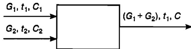
Рис. 5.16. Принципиальная схема теплообменника смешения
