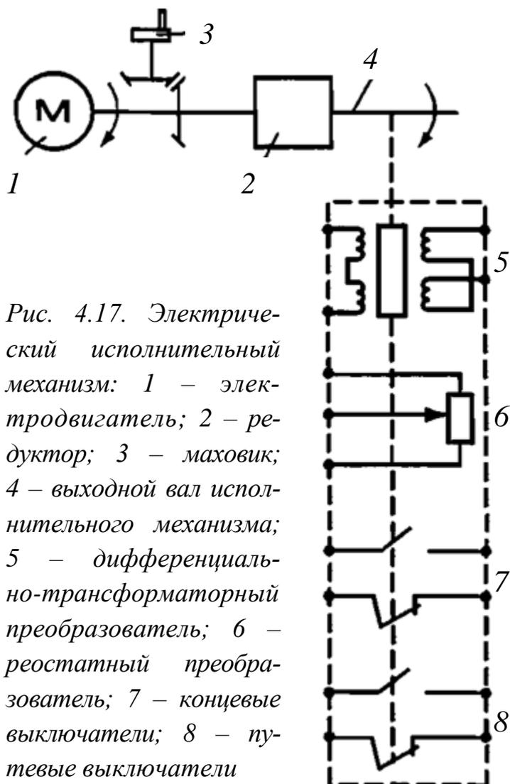
при достижении регулирующим органом крайних положений. Путевые выключатели служат для ограничения диапазона перемещения регулирующего органа. В автоматическом режиме работы они отключают пускатель при выходе за пределы установленного диапазона.
