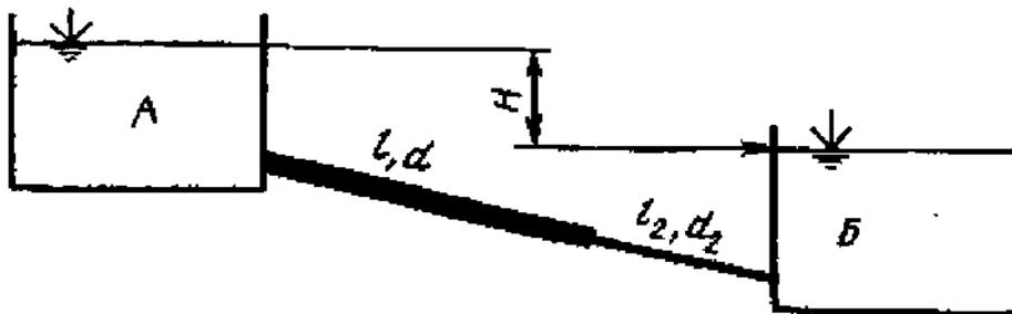
**Задача 5.** Из большого открытого резервуара А, в котором поддерживается постоянный уровень жидкости, по трубопроводу, состоящему из трех труб, длина которых  $l = 13$  м,  $l_1 = 13$  м,  $l_2 = 8$  м, а диаметры  $d = 40$  мм,  $d_1 = 32$  мм,  $d_2 = 32$  мм жидкость при температуре  $20^\circ\text{C}$  течет в резервуар Б. Разность уровней жидкости в резервуарах  $H = 7$  м.
