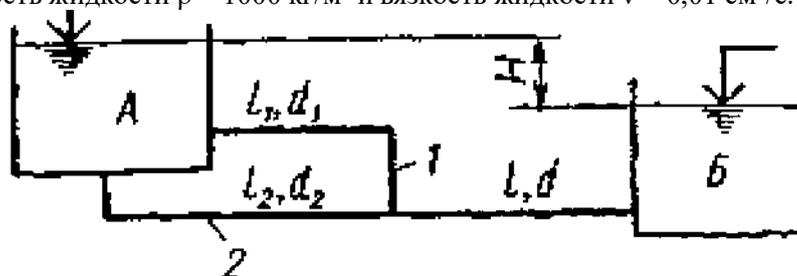
**Задача 6.** Определить расход жидкости, протекающей по трубопроводу в пункты 1 и 2, если напор  $H = 9$  м в резервуаре постоянный.
