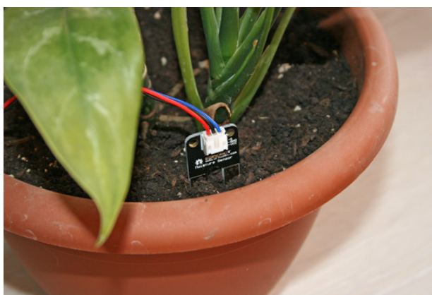
Рис. 114 Датчик влажности в цветочной плошке
