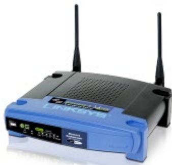
Рис. 28 Маршрутизатор Linksys WRT54G, успешно работающий мастером 1-wire сети
