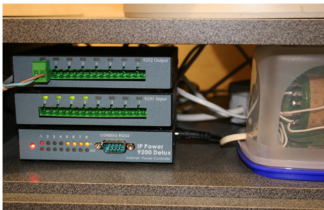
Рис. 102 Автополив с управлением по Ethernet/Интернет/Автоматически
