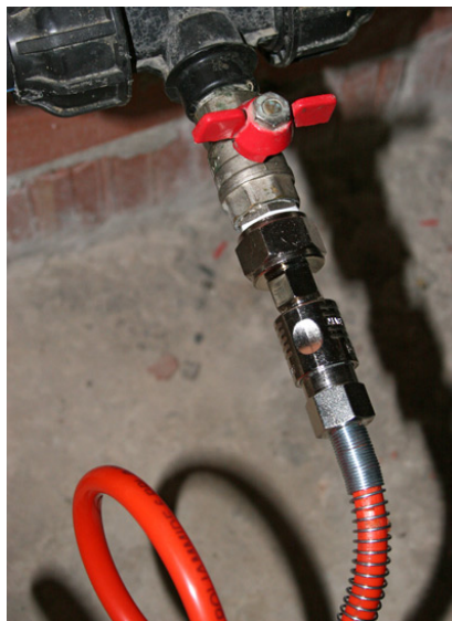
Рис. 111 Узел для подключения компрессоры rapid (быстросъёмное соединение)
