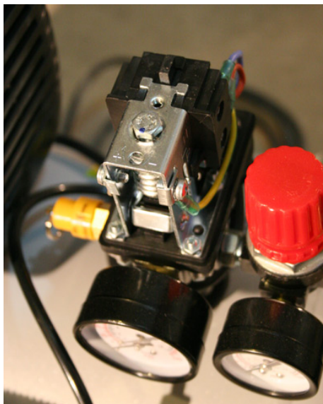
Рис. 112 Болт для регулировки порога отключения компрессора
