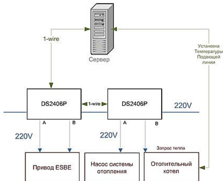
Рис. 53 Схема управления отоплением с помощью модулей 1-wire
