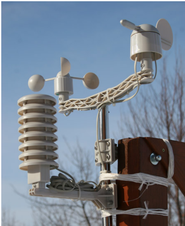
Рис. 78 Тестирование метеостанции. Внешние сенсоры пока без датчика осадков.
