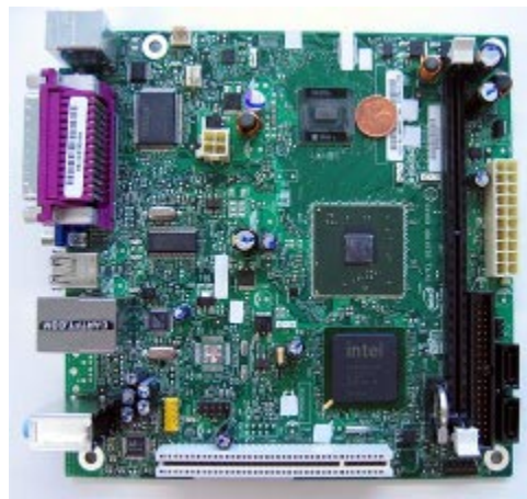
Рис. 29 Платформа Intel Atom в формате ITX - бесшумно и экономично
