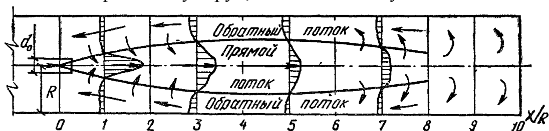
Рис.3. Схема струи, истекающей в тупик
