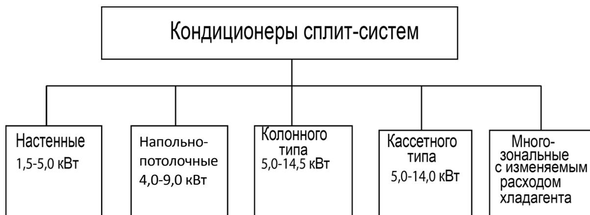
Рис. 4. Типы кондиционеров сплит-систем
