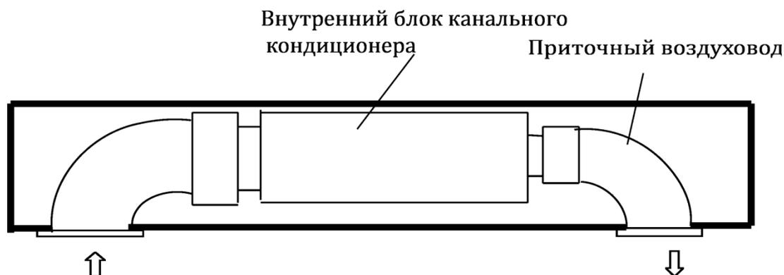
Рис. 5. Размещение внутреннего блока канального кондиционера
