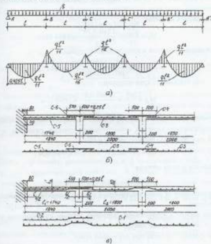
Рис. 2.3 Армирование монолитной плиты: а – расчетная схема и эпюра моментов; б – армирование дуговыми сетками; в – армирование плоскими сварными сетками
