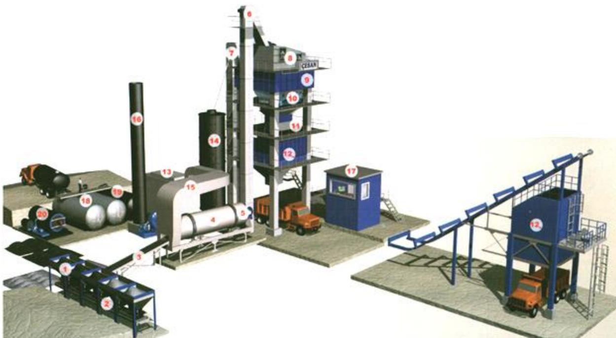
Рис. 1. Технологическая схема приготовления асфальтобетонной смеси:
