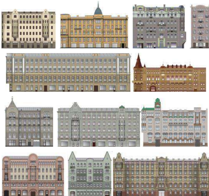
Рис. 19. Пример оформления карты стиля методом фотофиксации с последующим построением фасадов (по Семеновой). [13]
