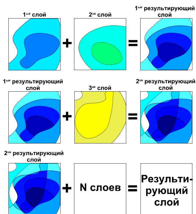
Рис. 2. Схема разрезания одного слоя другим
