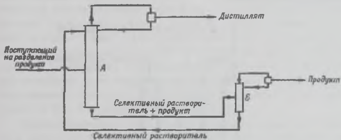
Рис. 4. Схема экстракционной перегонки.
