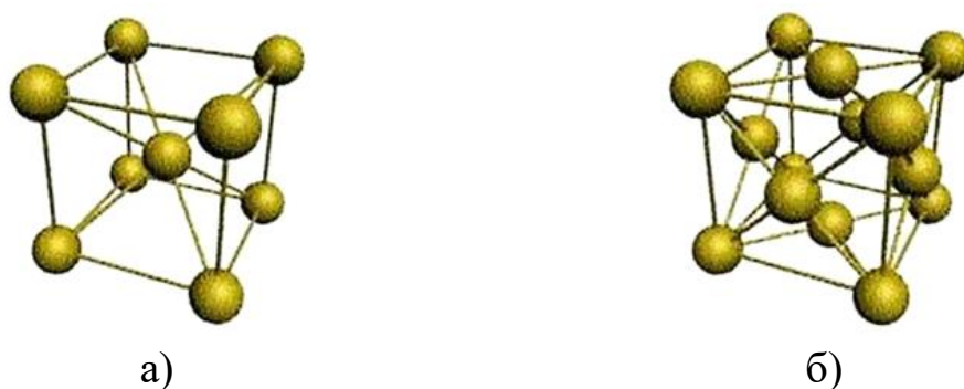
Рис. 15. Кубические кристаллические решетки металлов: а – объемно-центрированная; б – гранецентрированная
