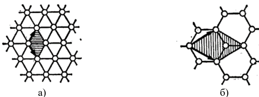
Рис. 60. Гексагональная двумерная решетка и ее элементарная ячейка (заштрихована): а – сложная, б – простая
