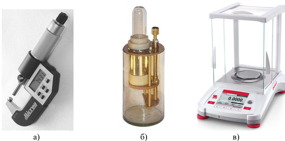
Рис. 1.17. Приборы для обмера образцов: а – электронный микрометр; б – прибор для определения объема образцов (ГОСТ 15139-69); в – аналитические весы
