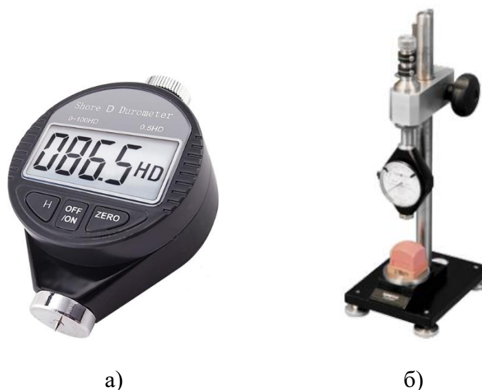
Рис. 1.13. Дюрометры (твердомеры) для определения твердости по Шору: а – ручной дюрометр; б – ручная модульная станция настольного исполнения
