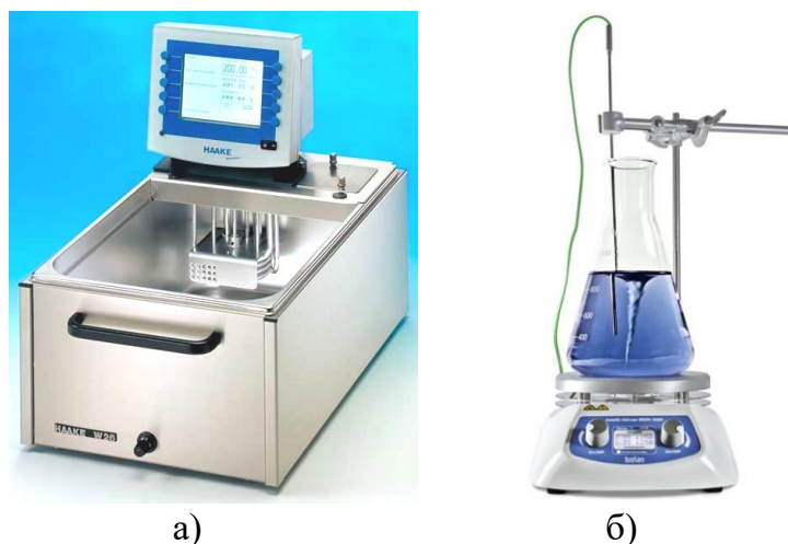
Рис. 1.20. Приборы для определения плотности флотационным методом: а – циркуляционный термостат; б – магнитная мешалка
