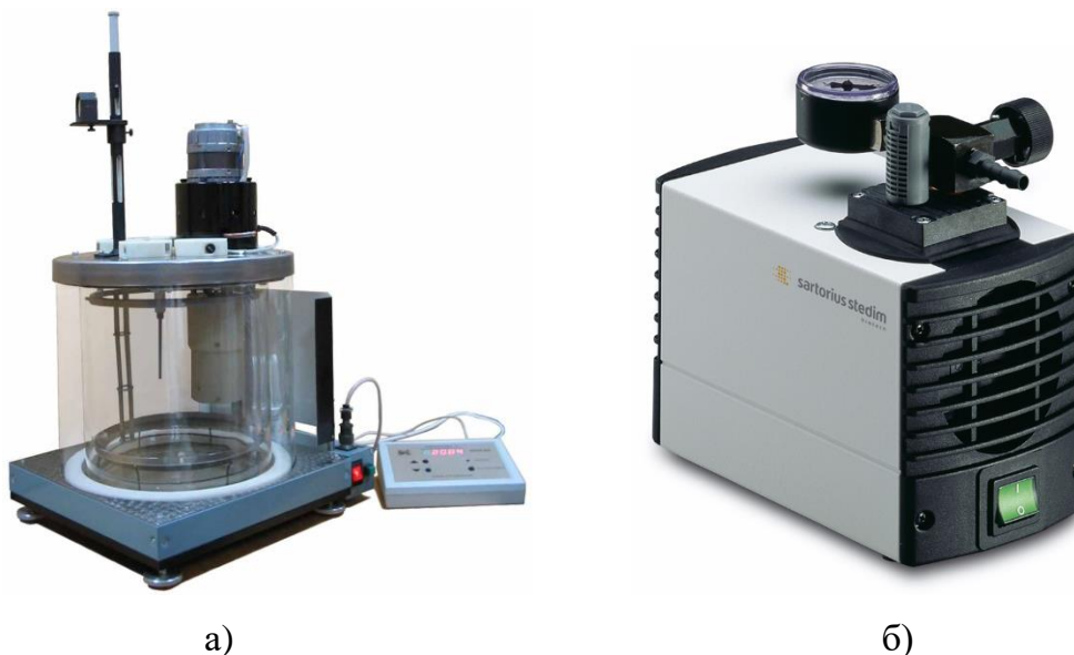
Рис. 1.19. Приборы для определения плотности пикнометрическим методом: а – высокоточный лабораторный термостат; б – лабораторный вакуумный насос
