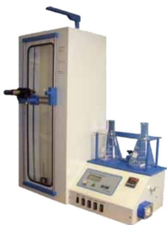
Рис. 1.23. Цифровое устройство для автоматического определения плотности методом градиентных колонок
