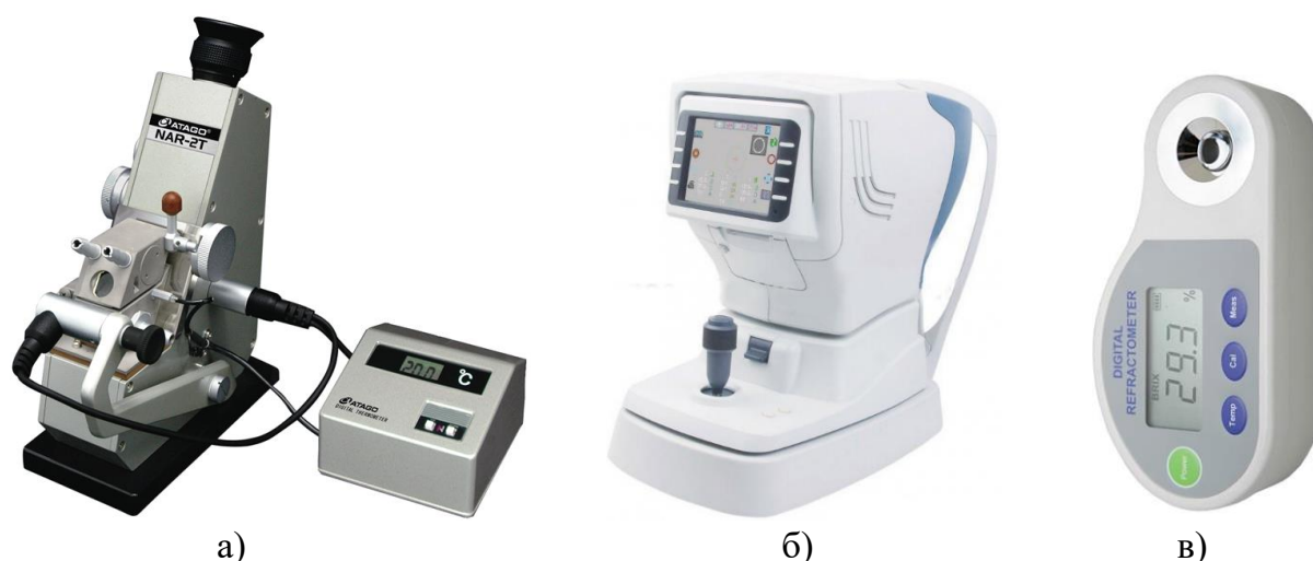
Рис. 3.6. Приборы для определения коэффициента преломления: а – рефрактометр; б – автоматический рефрактометр; в – рефрактометр ручной цифровой
