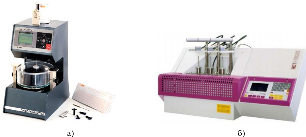
Рис. 6.1. Приборы для определения температуры размягчения по методу Вика: а – автоматический прибор Вика; б – прибор для определения теплостойкости
