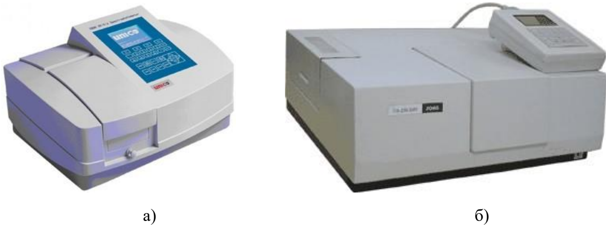
Рис. 3.1. Приборы для определения мутности и светопропускания: а – спектрофотометр однолучевой; б – автоматизированный двухлучевой спектрофотометр
