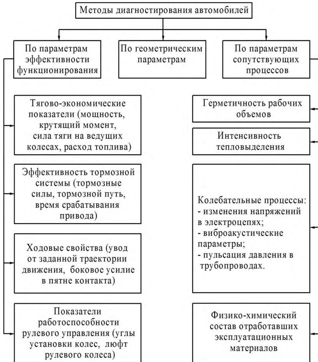
**Рис.8.9.** Классификация методов диагностирования автомобилей
