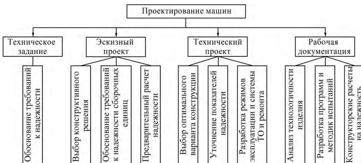
Рис. 7.1. Структурная схема процесса проектирования машины
