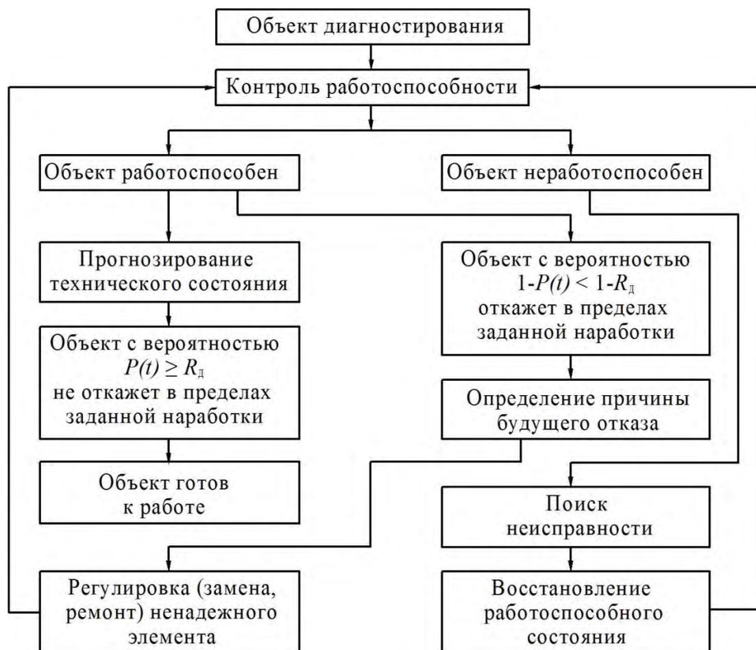
**Рис.8.8.** Схема технического диагностирования:
