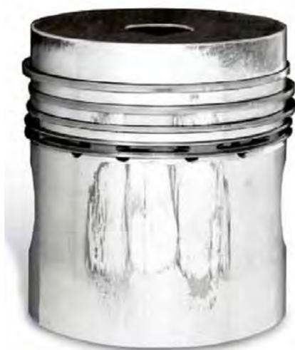
**Рис. 8.2.** Задиры на юбке поршня из алюминиевого сплава при работе с недостаточным количеством масла
