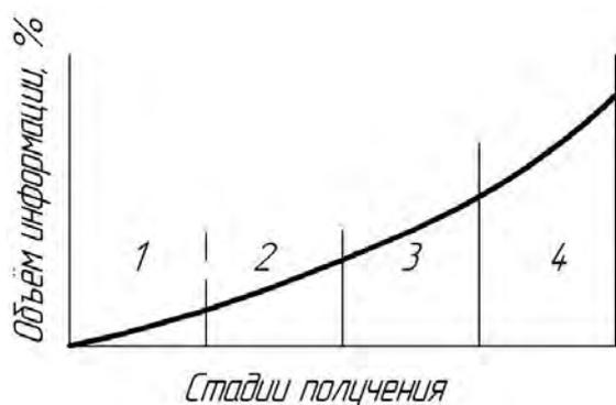
**Рис.5.4.**Схема изменения объема информации о надежности изделия на стадиях: 1 – расчеты при проектировании; 2 – доводочные испытания; 3 – испытания серийной партии; 4 – эксплуатационные испытания
