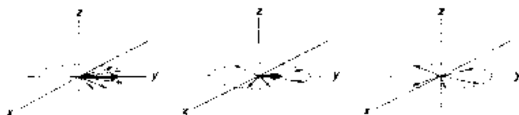
Рис. 3.101. Процесс релаксации поперечной намагниченности ядер в плоскости xy
