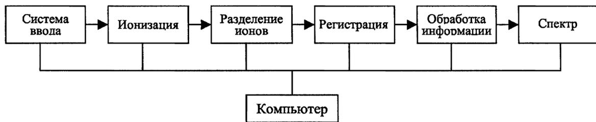
Рис. 1.2. Блок-схема масс-спектрометра
